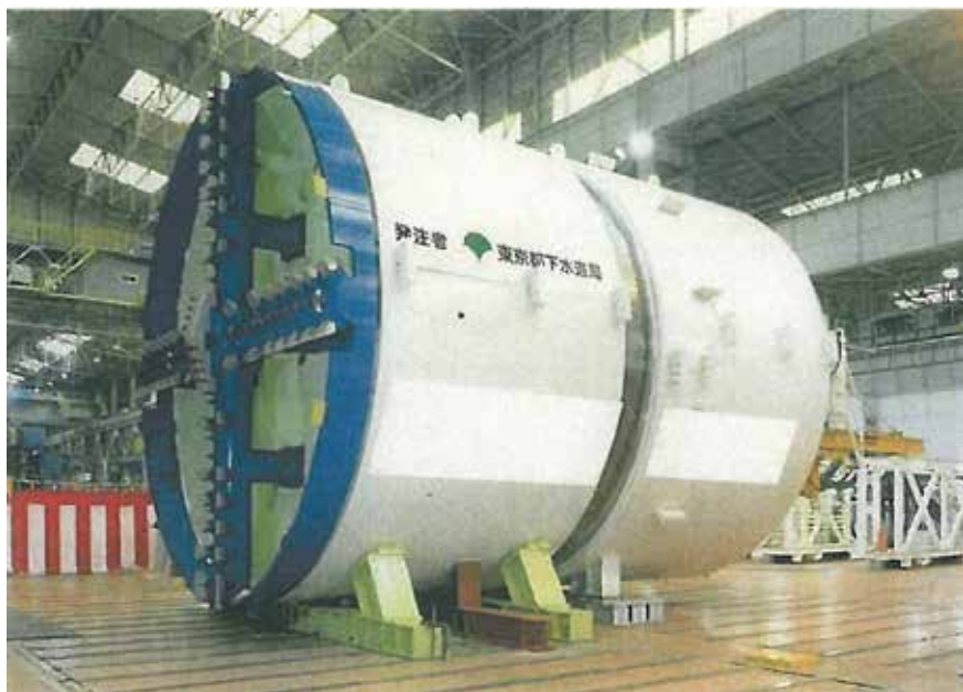
直径約4メートルのシールドマシン (下水道局提供写真)
